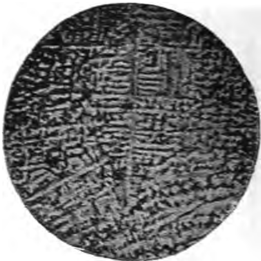
FIG. 8. — Bronze phosphore, d'après M. Guillemin.
